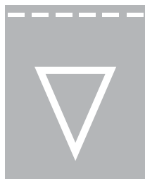
Γραμμή στάσης σε ποδηλατοδιάδρομο με παραχώρηση προτεραιότητας σε σημείο συμβολής της με δρόμο ή κύρια οχηματική πρόσβαση ανάπτυξης.
